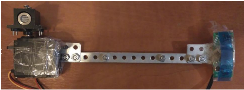
Рис.13. Система из камеры с синим фильтром и лазерного целеуказателя с сервоприводом
