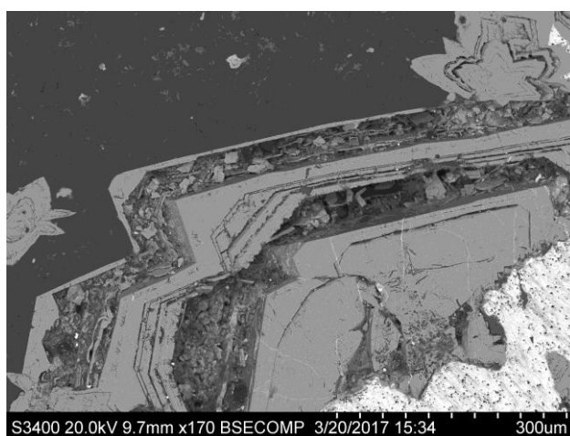
Рис.58. Изображение в обратноотраженных электронах, обр.№2-17 после выщелачивания
