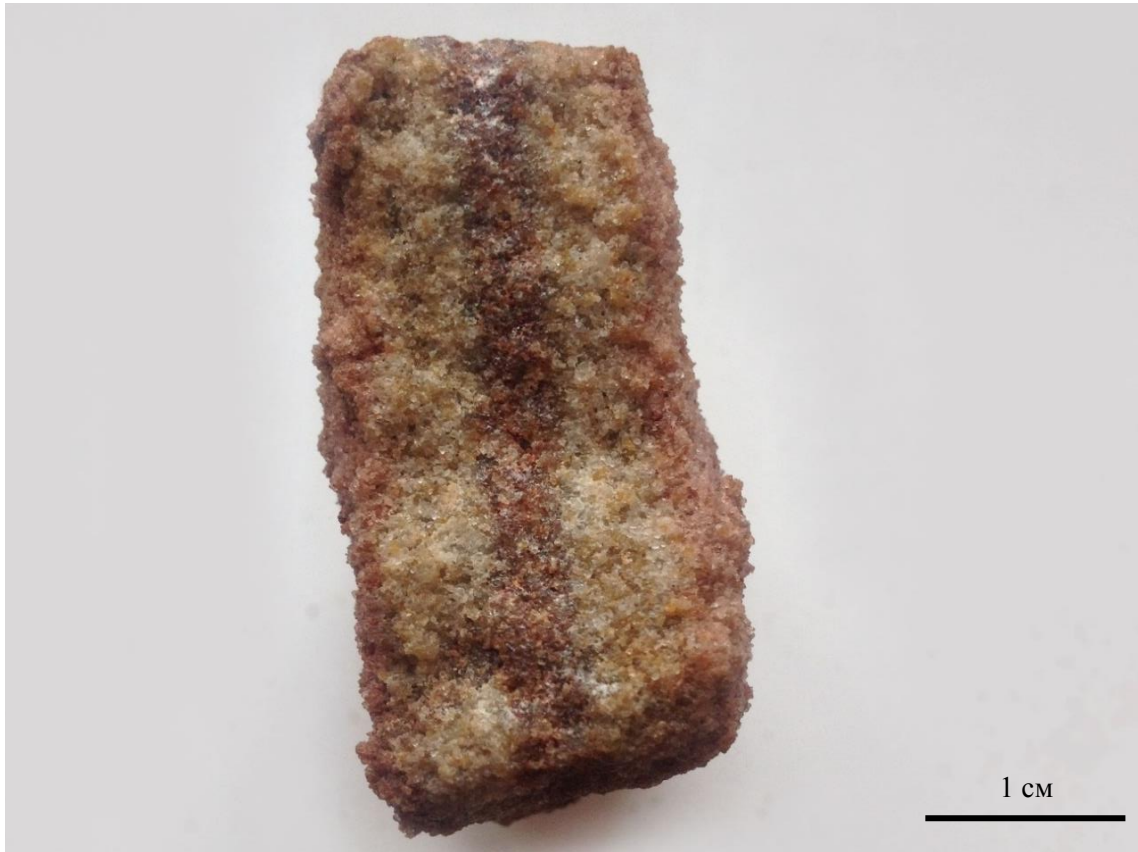
Рисунок 44. Образец трещины из кровли саблинской свиты. Отчетливо видно зональное строение: в центральной (бурой) части преобладает анкеритовый цемент, ближе к периферии – кремнеземный
