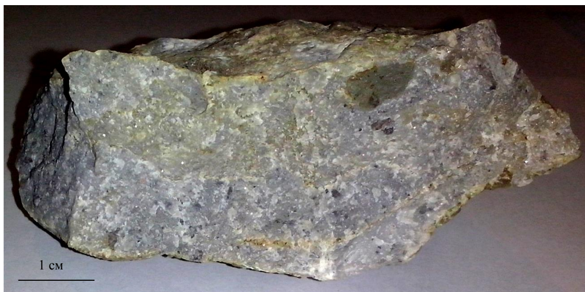
Рис.28. Вторичные кварциты с сульфидной минерализацией из зоны дробления (гидровулканический комплекс N 1-2 )
