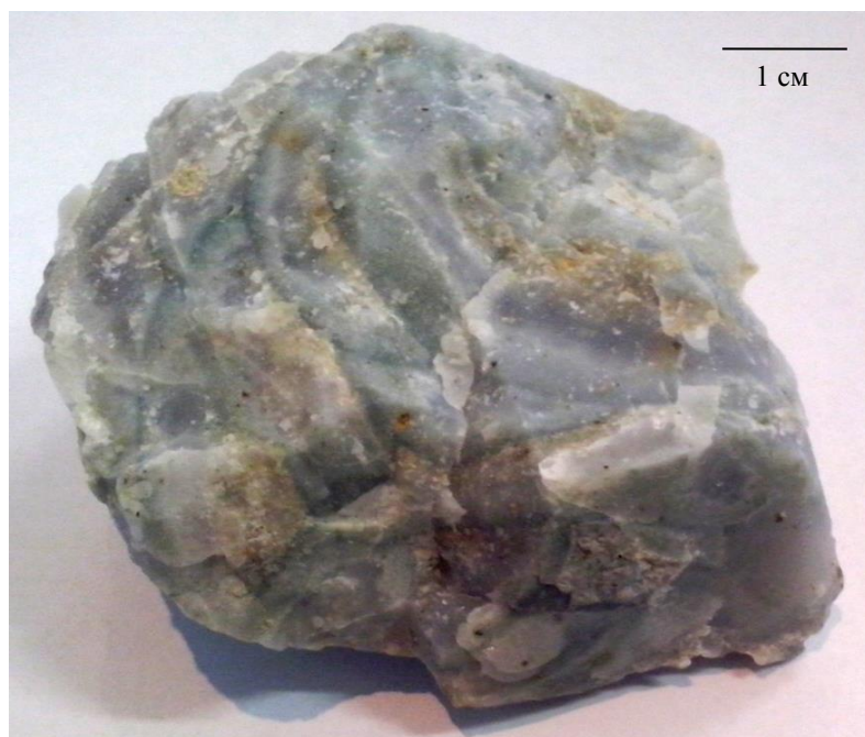
Рис.26. Вторичный кварцит с сульфидной минерализацией (карбонатно-кремнисто-вулканогенный комплекс К 1-2 )
