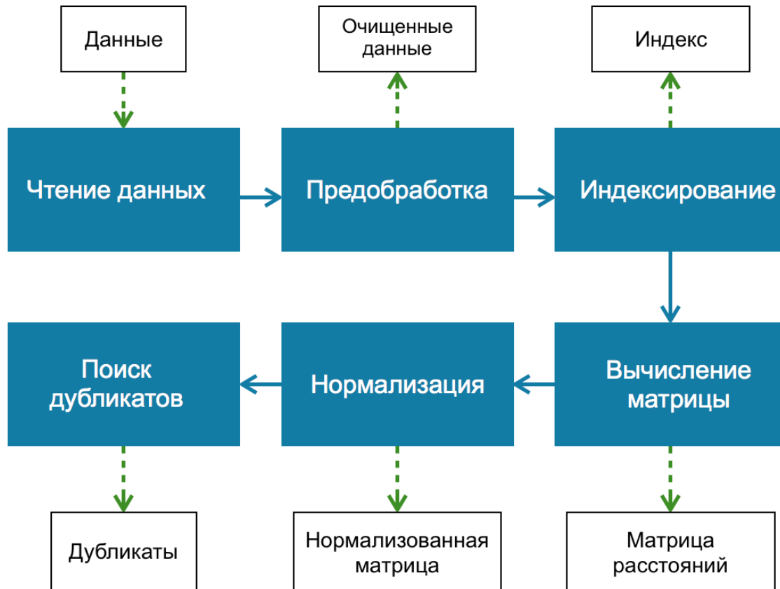
Рис.1. Схема взаимодействия модулей. Сплошные стрелки — передача данных между модулями. Пунктирные стрелки — чтение или запись данных.
