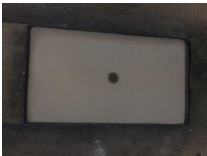
Рис. 17 Фото пластины-противоэлектрода после воздействия электрического ветра.
