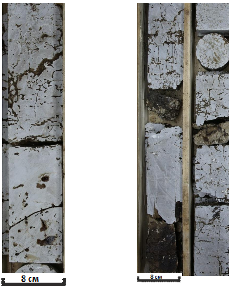
Рисунок 10. Известняки биогермные сферово-водорослевые с граноморфным заполнителем( баундстоуны) скв. 464, инт. 1651-1684 и скв. 656, инт. 1366-1380 соответственно
