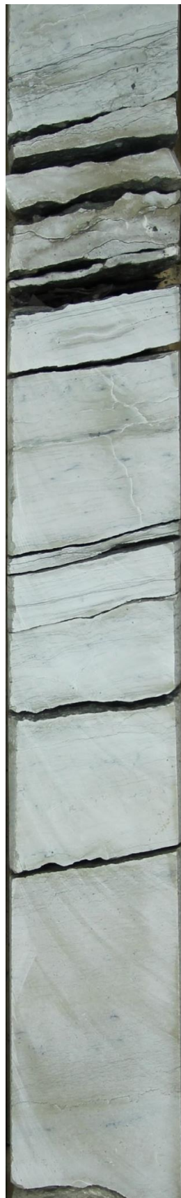
Рисунок 15 Известняк микро-сгустковый водорослевый(мадстоун) скв. 706, инт. 1712-1726, скв. 9, инт.1782-1796, скв. 464, инт. 1651-1684 соответственно
