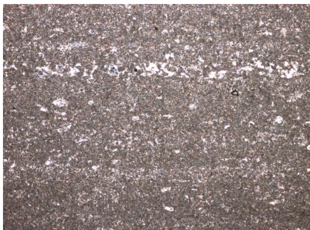
Рисунок 12 Известняк слоистый с реликтовой водорослевой структурой сгустковый (баундстоун) (часто структура выражена слабо). Скв.705 Туркеевского ЛУ. Инт. 1691,0-1705,0 м. Обр.69. Шлиф, фото с анализатором. Длина рисунка 2 мм.
