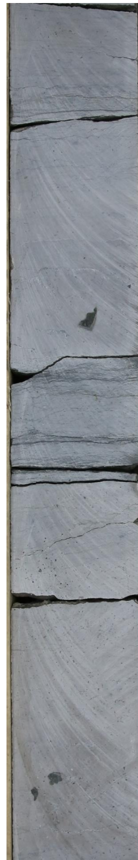
Рисунок 15 Известняк микро-сгустковый водорослевый(мадстоун) скв. 706, инт. 1712-1726, скв. 9, инт.1782-1796, скв. 464, инт. 1651-1684 соответственно
