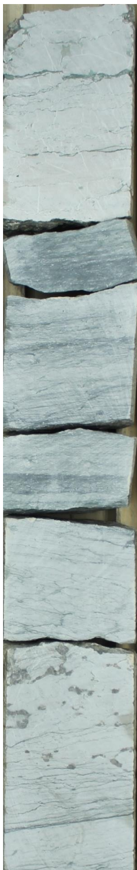
Рисунок 15 Известняк микро-сгустковый водорослевый(мадстоун) скв. 706, инт. 1712-1726, скв. 9, инт.1782-1796, скв. 464, инт. 1651-1684 соответственно
