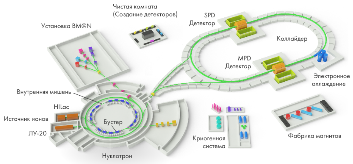
Рис. 1: Схема строящегося ускорительно-накопительного комплекса NICA
