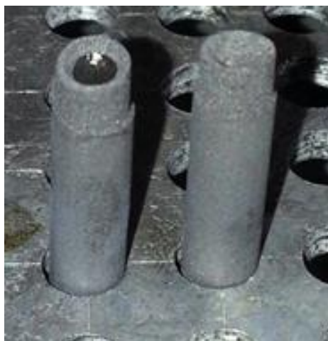
Рисунок 11. Внешний вид графитового электрода с сахарной пленкой (слева) и без нее (справа)
