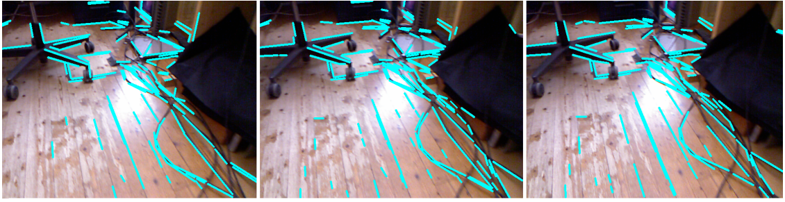
Рис. 3: Последовательность из трех кадров с отмеченными линиями, соответствующими друг другу.
