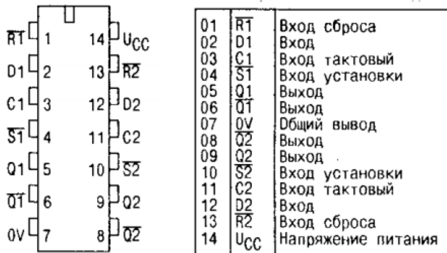
Рисунок 11 Расположение и назначение выводов 1533TM2
