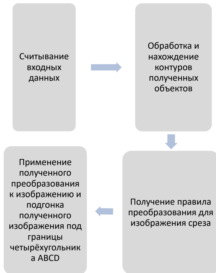
Рис.15. Схема работы алгоритма получения данных для каждого среза.
