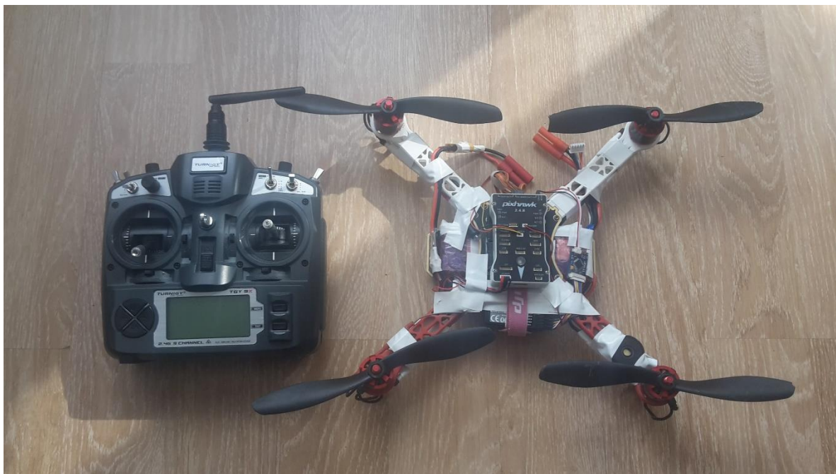
Рис. 3.1. Созданный квадрокоптер и пульт управления
