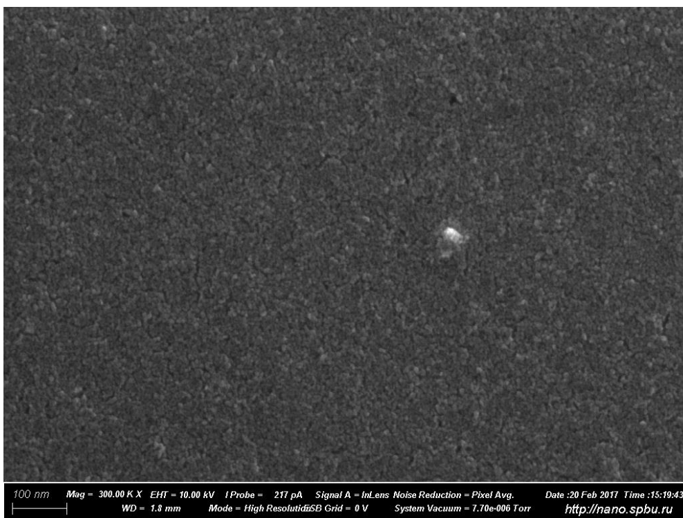
Рис. 9. Микрофотография поверхности пленки TiO_2 образца 6.3
