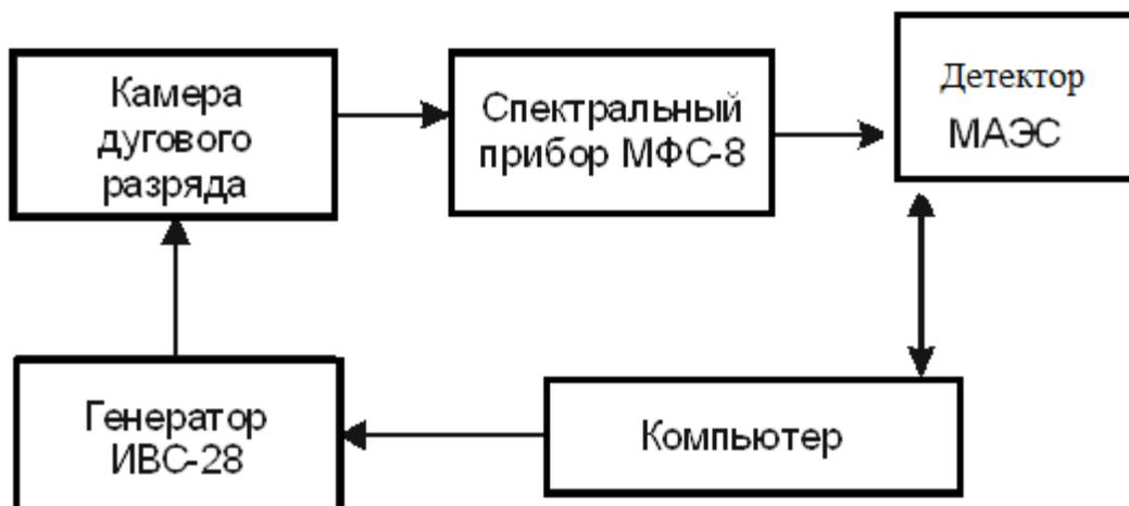
Рисунок 1. Схема используемой для анализа установки
